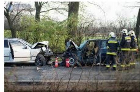
12. ábra. Két személygépkocsi, frontális ütközése teljes átfedéssel
