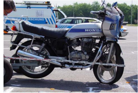
11. ábra. A motorkerékpár falnak ütközési sebessége 58 km/h volt
